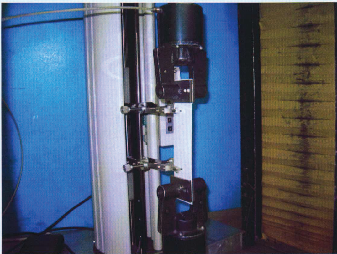
Photographie d'un échantillon soumis à la traction.
